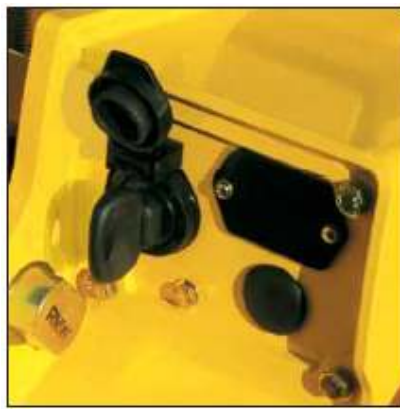
Rozrusznik elektryczny dla komfortowej obsługi (wyposażenie seryjne w BPR 65/70 D).
