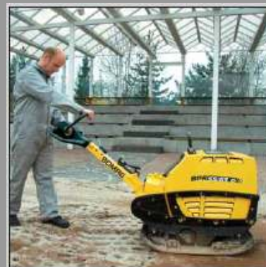
Dyszel prowadzący może być bezstopniowo regulowany na wysokość dla zapewnienia ergonomicznej obsługi.
