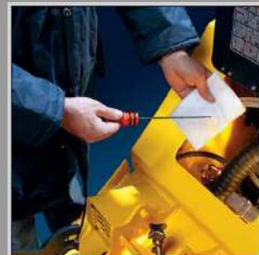
Dobry dostęp do punktów serwisowych, jak przetowy wskaźnik poziomu oleju, filtr powietrza, zbiornik paliwa, itd.
