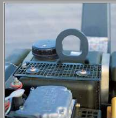
Centralne zawieszenie jednopunktowe i boczne otwory mocujące zapewniają szybki i bezpieczny transport.
