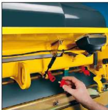
Praktyczne detale: Dysze chronione są przed wiatrem za zasłoną, a mimo to pozostają łatwo dostępne.
