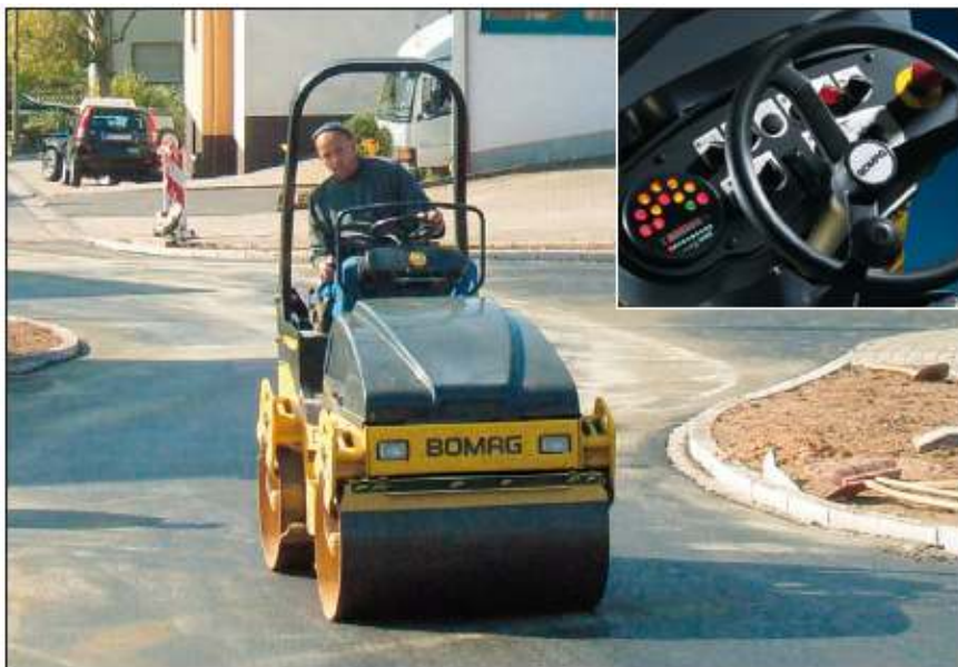
BW 120 AD-4: Izolowane od drgań stanowisko pracy operatora; dobra widoczność dzięki nachylonej masce silnika i pochylonym wspornikom.
