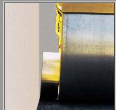
3 narzędzia do zadań wielofunkcyjnych; wałek stożkowy zagęszcza w sposób ciągły, do samej ściany
