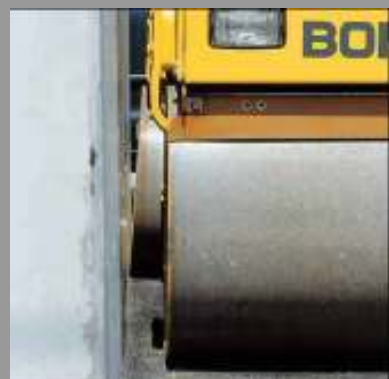
BW 80 ADS przy ścianie: bez uszkodzeń, bez obróbki wykończającej
