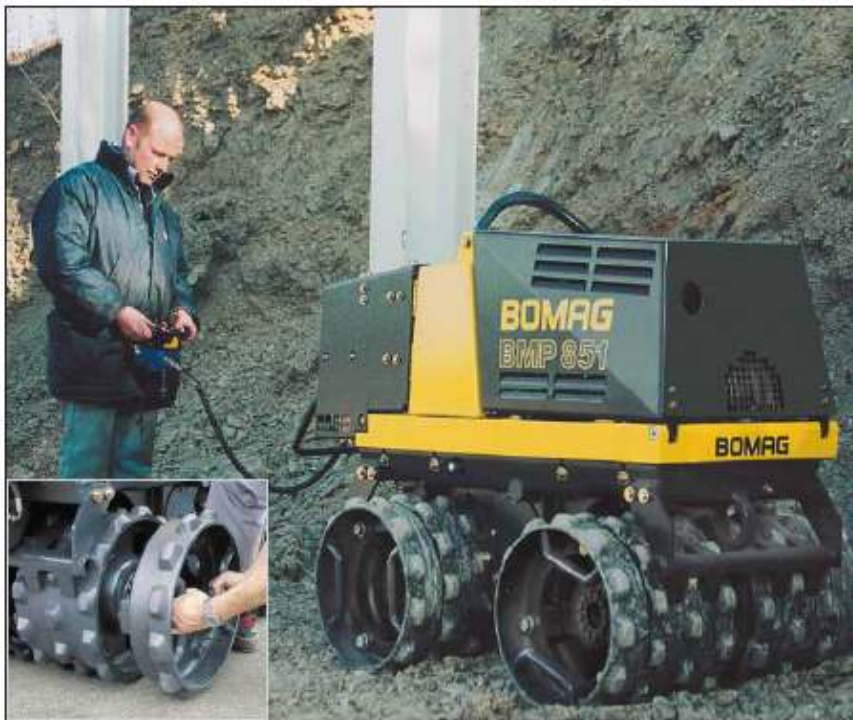
Jedna maszyna - dwie szerokości robocze. Dostępny opcjonalnie zestaw do poszerzania bębnow (610/850 mm) pozwala na dopasowanie szerokości roboczej w ciągu kilku minut
