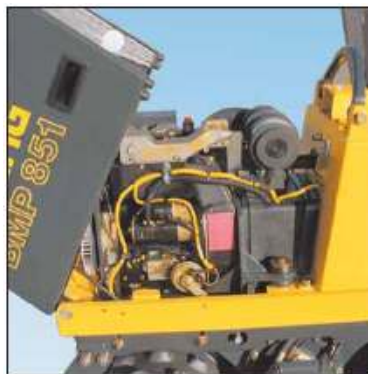
Duże rezerwy mocy, nawet w ekstremalnych warunkach, oferuje 2-cylindrowy silnik wysokoprężny Hatz o wysokim momencie obrotowym z układem automatycznego wyłączenia w przypadku braku oleju
