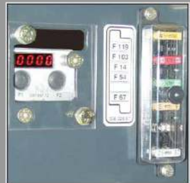
Łatwy w serwisowaniu moduł diagnostyczny ze wskaźnikiem kodu błędów, licznikiem roboczogodzin i odłącznikiem akumulatora pod pokrywą w przednim ramie.
