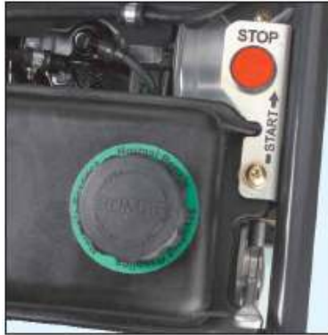
Bezpieczny w obsłudze: Wyłącznik zatrzymania silnika zintegrowany w pałąku prowadzącym
