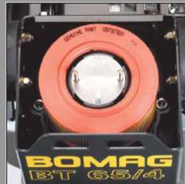
Niskie nakłady na konserwację dzięki samoczyszczącej się obudowie filtra powietrza i wkładowi filtra powietrza o dużej powierzchni
